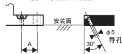
图2 导孔加工详图
